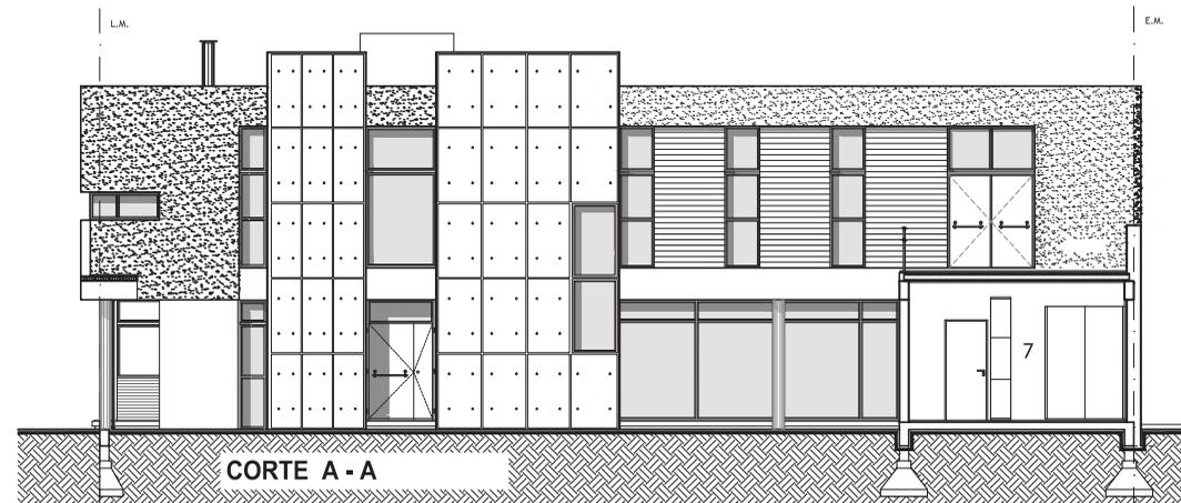
Constructivamente el edificio se materializa en una estructura de H<sup>º</sup>A<sup>º</sup> principal, mampuestos de ladrillos cerámicos con revestimientos texturados exteriores, carpinterías de aluminio prepintado negro, y tabiques diseñados y modulados a partir de vanos, vigas, antepechos y muros. Con esto el edificio se ordena en relación a módulos estructurales que organizan la planta y elevación.
